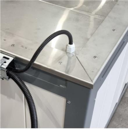
**Stufenlose Messung der Flüssigkeitsmenge in jedem Tank**
